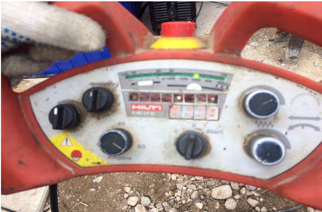
Пульт дистанционного управления дисковой пилой при резке бетона под водой.
