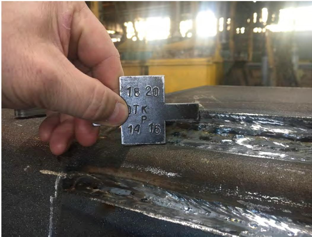
**Проверка стыковки шпунта после электросварки.**
