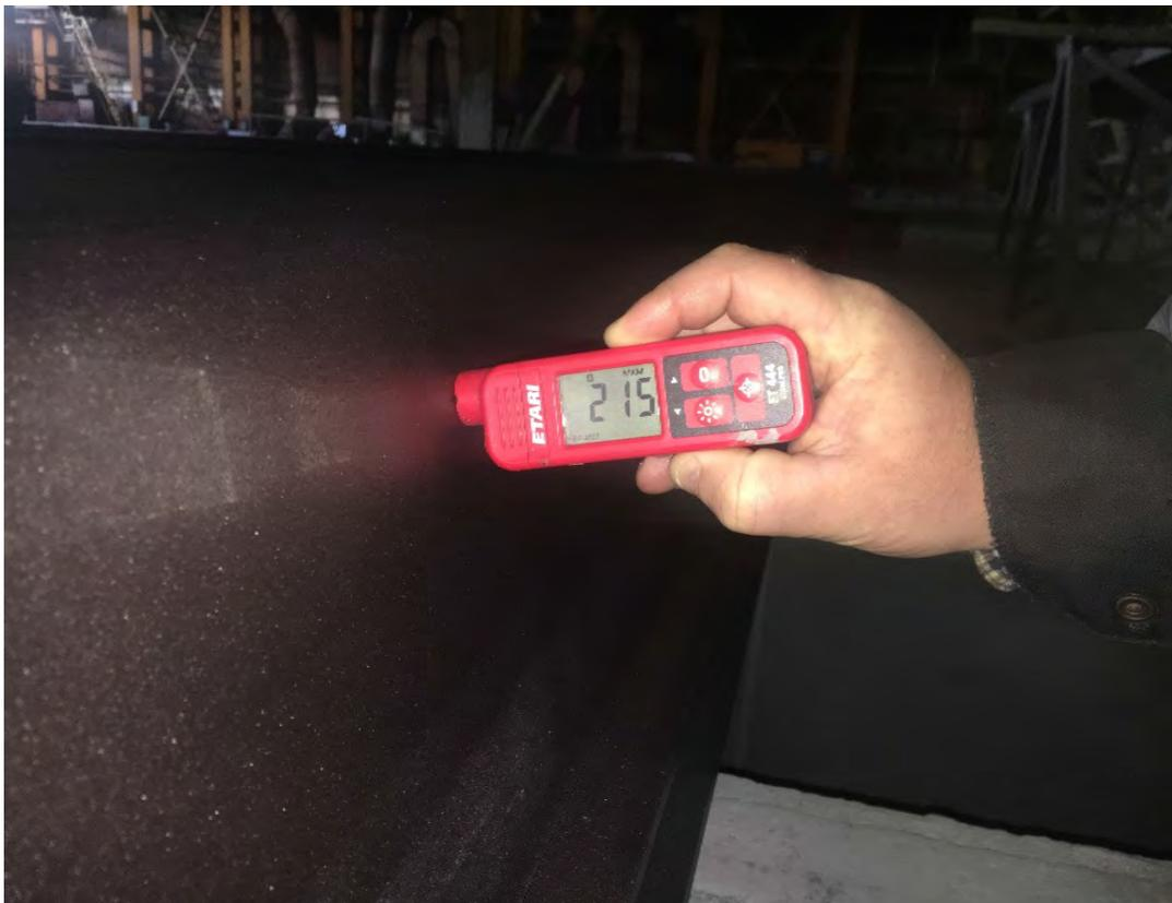
**Проведение замеров толщины антикоррозионного покрытия.**
